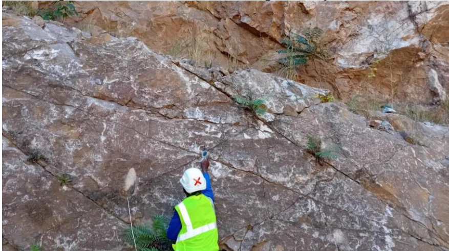
Imagem 3: Fracturas observadas no segundo stop na Mineradora
